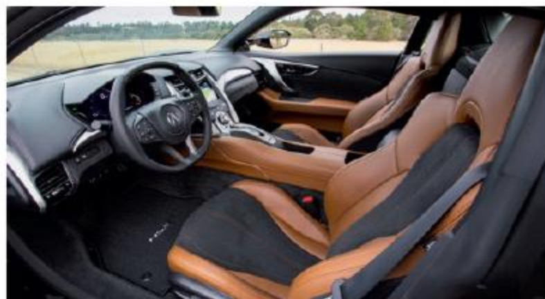
Рулевое управление оснащено электроусилителем с прогрессивной характеристикой, а от упора до упора обод делает меньше двух оборотов. В качестве опции есть отделка интерьера углепластиком. Из него же за доплату могут сделать и панель крыши (она изначально алюминиевая)
