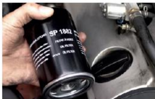
Старый масляный фильтр следует менять на новый при каждой замене масла
