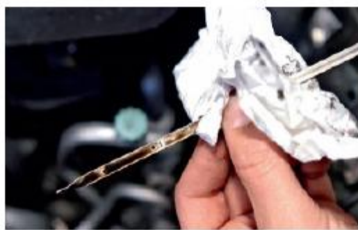
Рекомендуем контролировать уровень масла через каждые три заправки топливом
