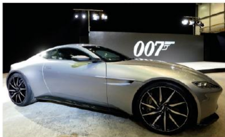
Купе DB10 создано на базе модели V8 Vantage, но с удлинненной колесной базой и расширенными колеями. Автомобиль приводится в движение восьмицилиндровым бензиновым двигателем объемом 4,7 литра, мощность которого составляет 436 лошадиных сил.
