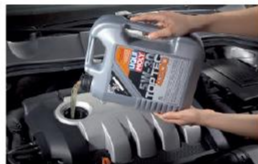
Заливать новое масло тоже лучше всего в горячий мотор – так оно легче заполнит все каналы и доберется до поддона
